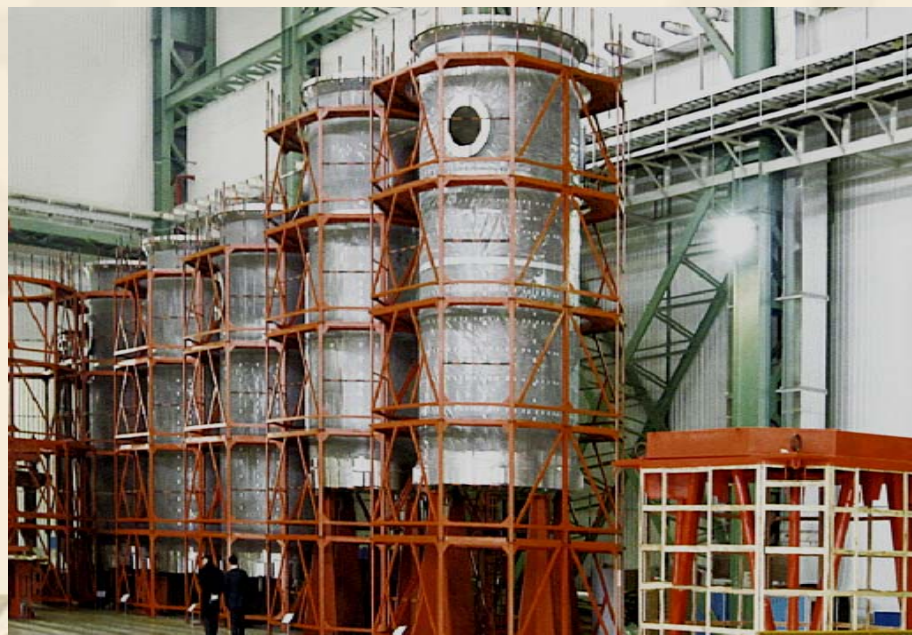
1000MW吊篮筒体
