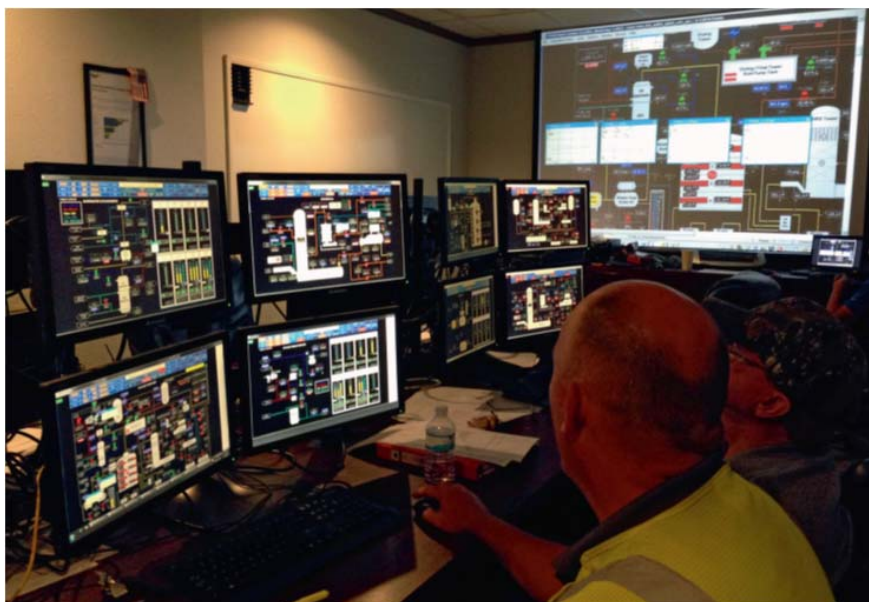
操作人员培训仿真器模拟客户的装置、控制方案和DCS显示屏
